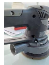
Carter d'aspiration associé à un disque perforé
