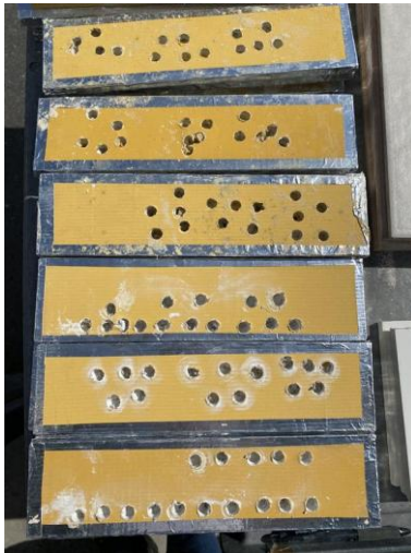
Photographies des perçages et ponçages des coupons de peinture
