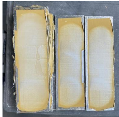
Photographies des perçages et ponçages des coupons de peinture
